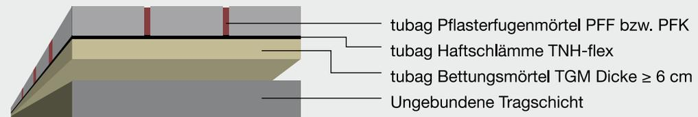
Plattenbeläge aus Keramik/Feinsteinzeug **wasserundurchlässig** verfugt. Auf wasserdurchlässiger ungebundener Tragschicht (N1 gem. ZTV Wegebau)
